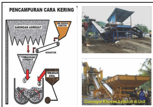
Gambar 4.5 Proses produksi Asbuton butir B 50/30.
