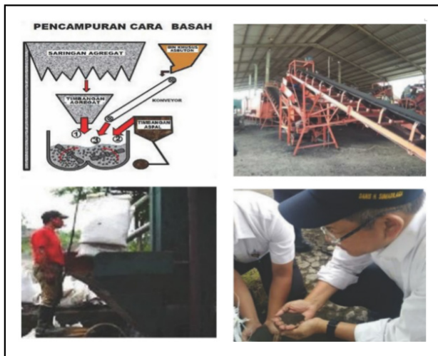
Gambar 4.2 Proses produksi Asbuton butir B 5/20.
