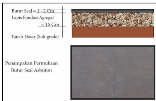
Gambar 5.2 Potongan melintang dan penampakan permukaan perkerasan jalan Butur Seal Asbuton
